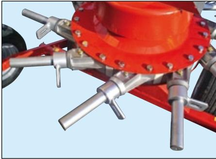
Bracci del rotore disposti tangenzialmente per una migliore qualità della rastrellatura e della formazione dell'andana con velocità di lavorazione elevata. Scatola di guida integralmente protetta con lubrificazione a grasso, braccetti comandati con rulli portanti su cuscinetto a sfere autolubrificanti: usura ridotta e manutenzione non necessaria.
