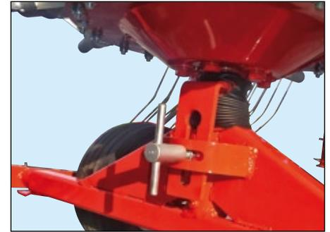
Ottimizzazione dell'andana grazie alla possibilità di anticipare o posticipare la presa e lo scarico del prodotto tramite regolazione della camma agendo dall'esterno sulla vite con impugnatura. Possibilità di regolazione lineare dell'altezza tramite manovella.
