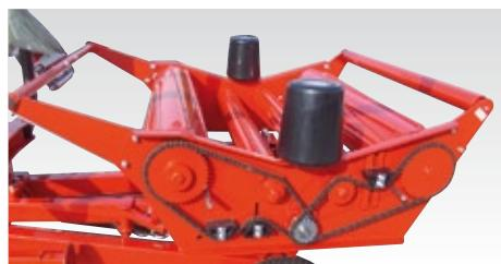
Piattaforma rotante appoggio con 4 rulli motorizzati e rullo di appoggio. Rotating platform with driven rollers and external roller. Plate-forme tournante avec rouleaux motorisés et rouleau externe.
